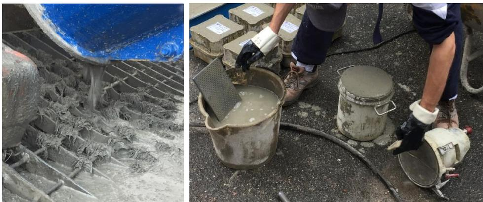
Sono stati confezionati anche dei provini per calcolare le resistenze a compressione ed a trazione per flessione sul calcestruzzo una volta indurito e maturato.
