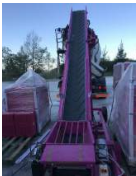
Figura 3-4. Nastro trasportatore automatico di fibre in autobetoniera, presso impianto di fornitura di calcestruzzo
