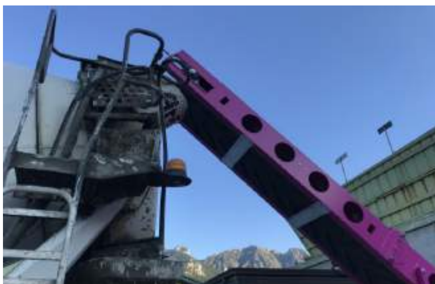
Figura 3-4. Nastro trasportatore automatico di fibre in autobetoniera, presso impianto di fornitura di calcestruzzo
