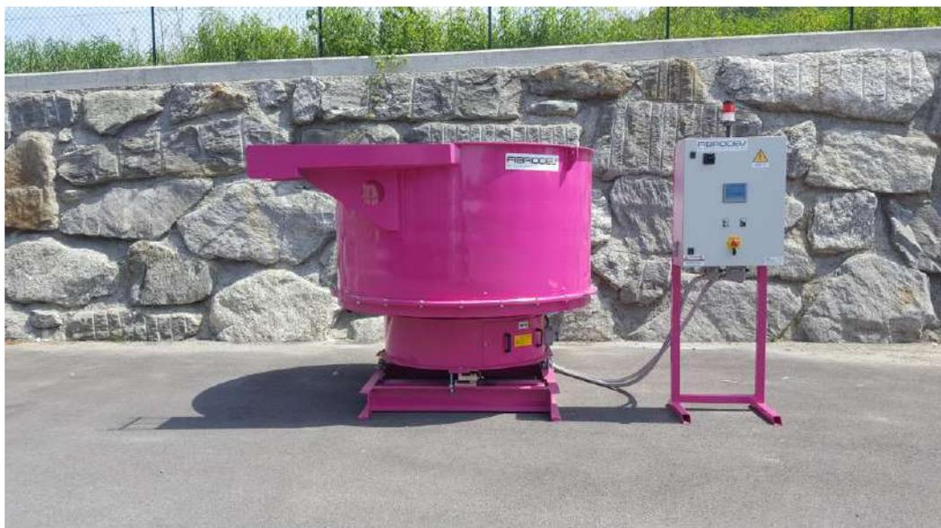
**Figura 2.** Impianto dosatore di fibre automatico ( conforme a Industria 4.0 )
